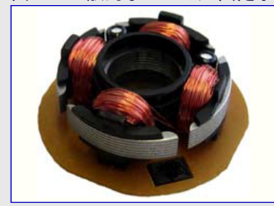
図3-2. 一般的なBLDCファン固定子
