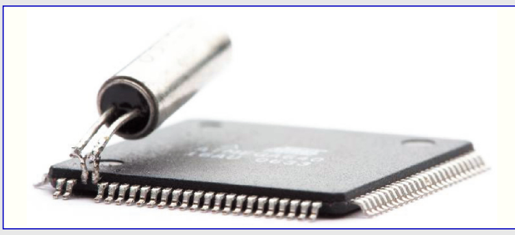
図3-5. 狭いピンピッチを持つ100ピンTQFP外囲器(例えばATmega6490, ATmega2560, ATxmega128A1)も使用可能ですが、半田付け時に震えない手が必要です。
