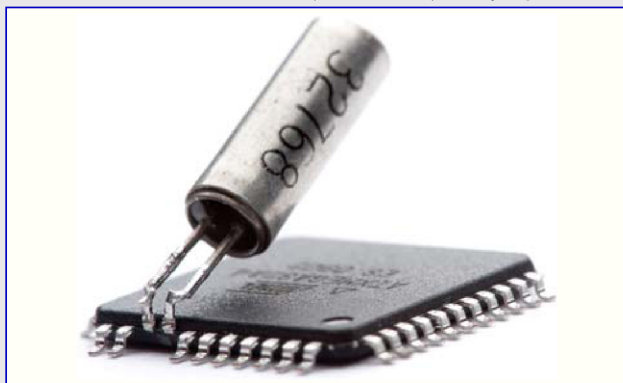
図3-2. 曲げたXTAL/TOSCリードへのクリスタル直半田付け
