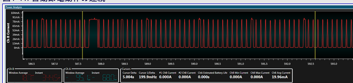
図4-11. 自動節電動作の連続
