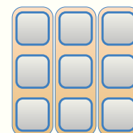
図3-7. 群として一括にされる複数釘で低電力感知器として構成設定
