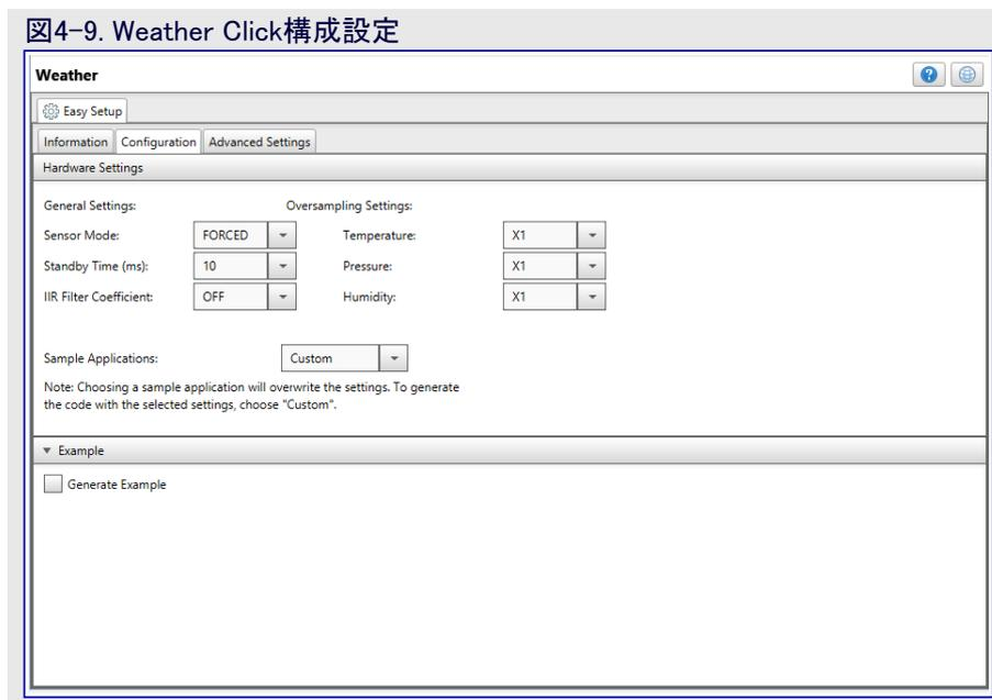
Weather Click資源が追加されると、他の2つの単位部がライブラリに、その後にFoundation Services(基本サービス)引き落としメニューに設定されます。これらはDELAYとI2CSIMPLEです。DELAYで変更を行うことができない一方で、I2CSIMPLE単位部は主装置としてTWIの周辺機能実体を必要とします。現在の応用でTWI0だけが許可される場合、MCCは既定によってそれを選びますが、TWI周辺機能でいくつかの実体がある時に注意が払われなければなりません。
