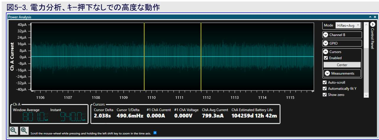
2つ目の図で見られるように鉤が繰り返して押されてデバイスによって走査される時に消費電力はCPUが休止している時よりもかなり高くなりますが、鉤を押し続けている時に約80 $\mu$ A、平均で約30 $\mu$ Aと未だ非常に低いです。
