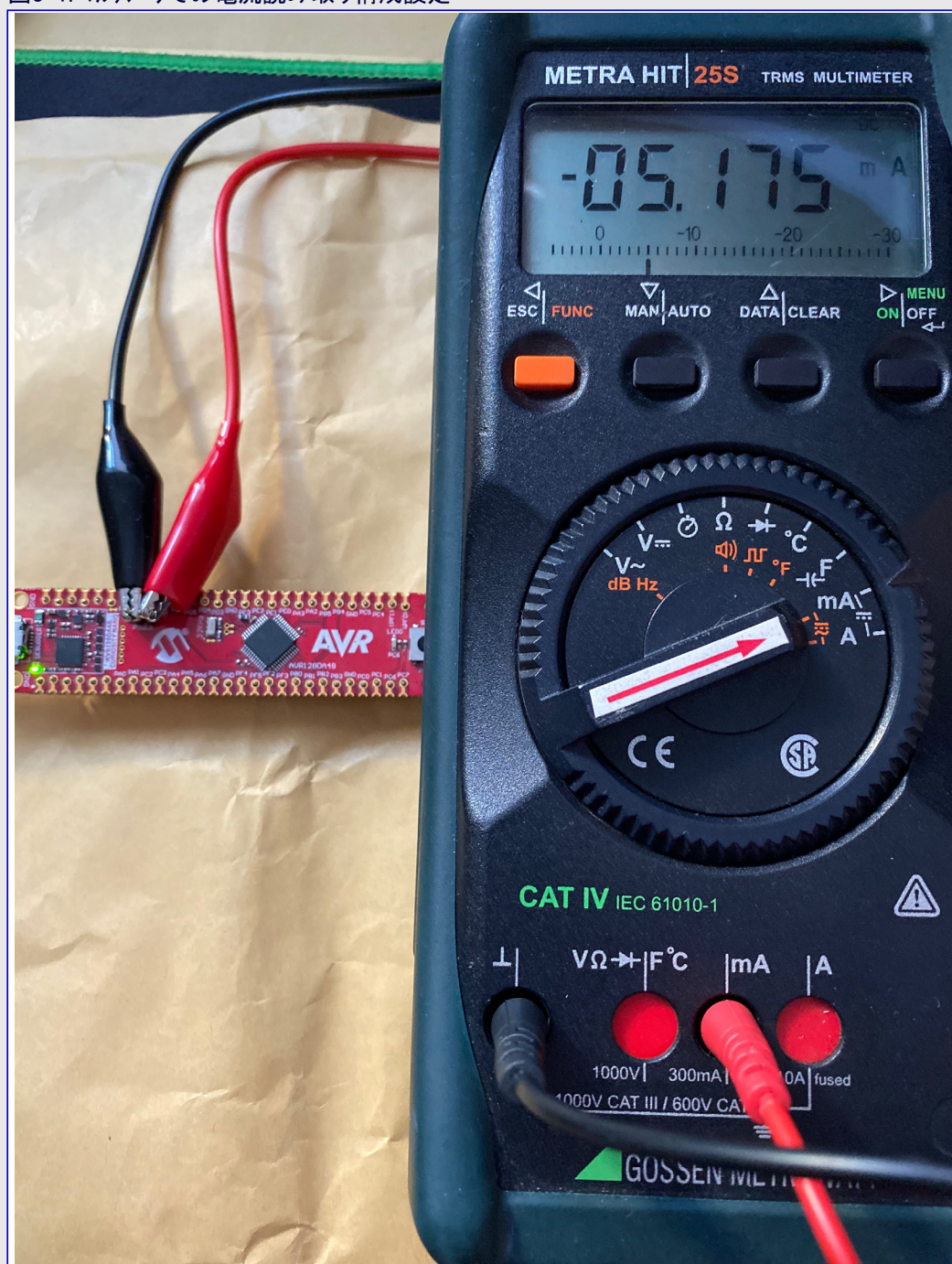
図3-1. マルチメータでの電流読み取り構成設定
