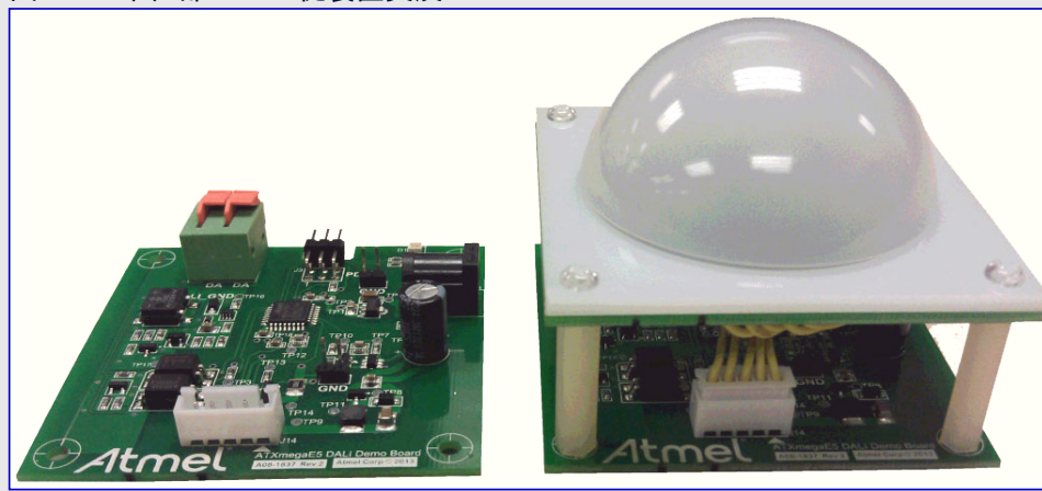
図1. LED単位部のDALI従装置実演
