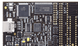
図7. より速いPDIとJTAGインターフェースだけでなくLiveデバッグも支援するAVR ONE!
