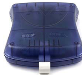
図4. チップ上デバッグとしての機能も持つJTAGICEmk II
