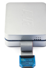
図7. より速いPDIとJTAGインターフェースだけでなくLiveデバッグも支援するAVR ONE!
