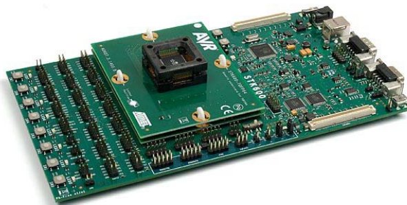
図3. STK600 – 即実行、クロック発生器、書き込み器、けれどもデバッグ不可
