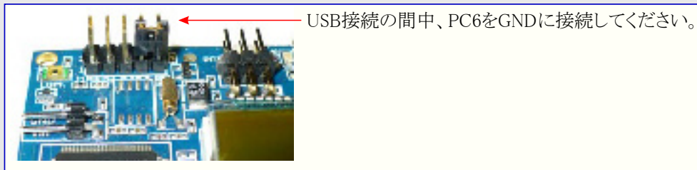
図6-2. USB接続の間中、PC6をGNDに接続
