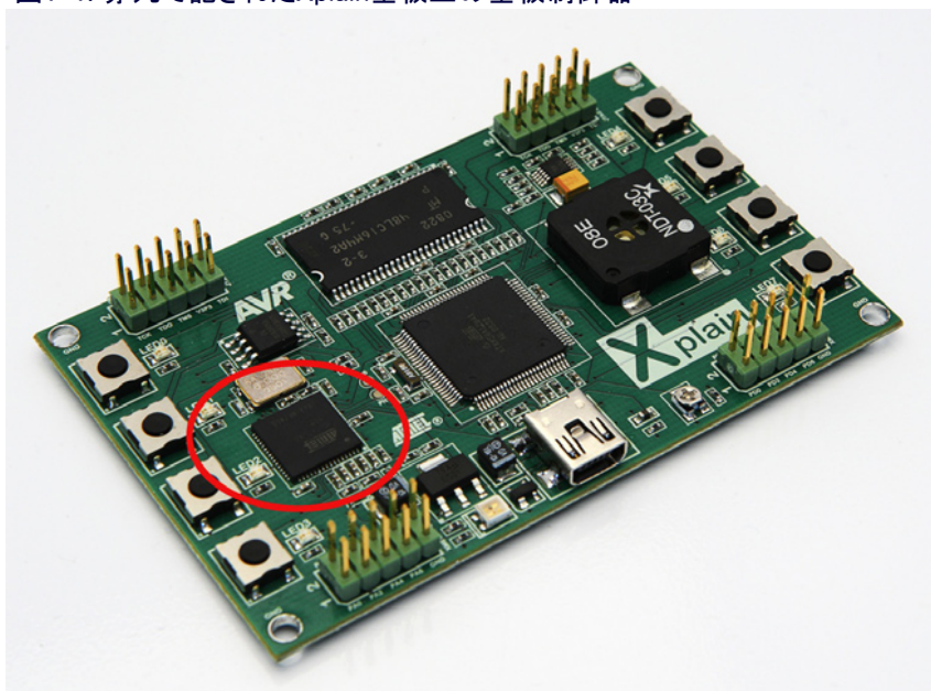
図1-1. 赤丸で記されたXplain基板上の基板制御器
