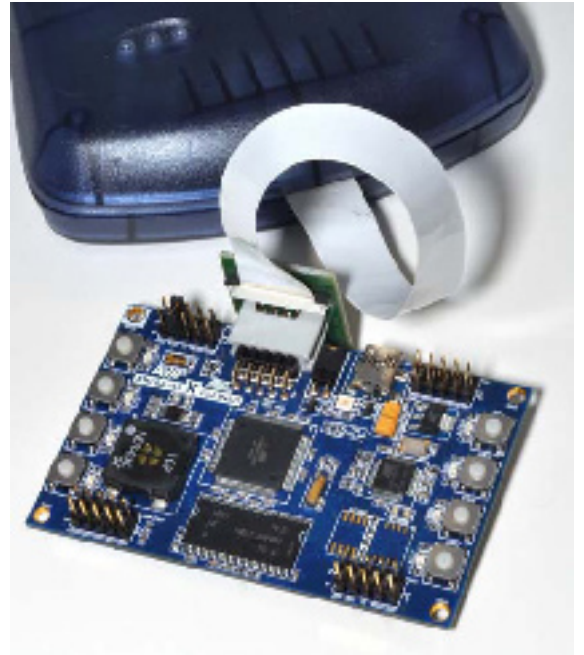
図4-2. Xplain基板へのAVR JTAGICEmk II 探針接続
