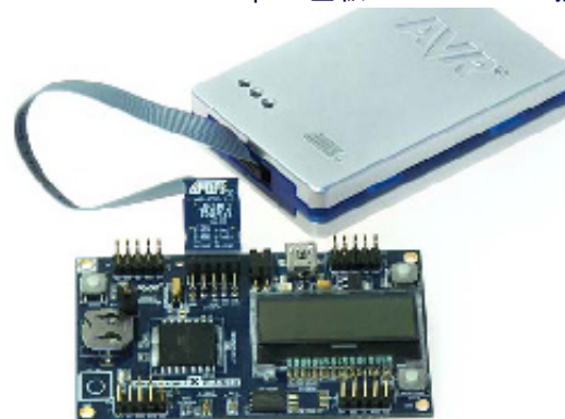
図4-1. XMEGA-A3BU Xplain基板へのJTAGICE3接続
