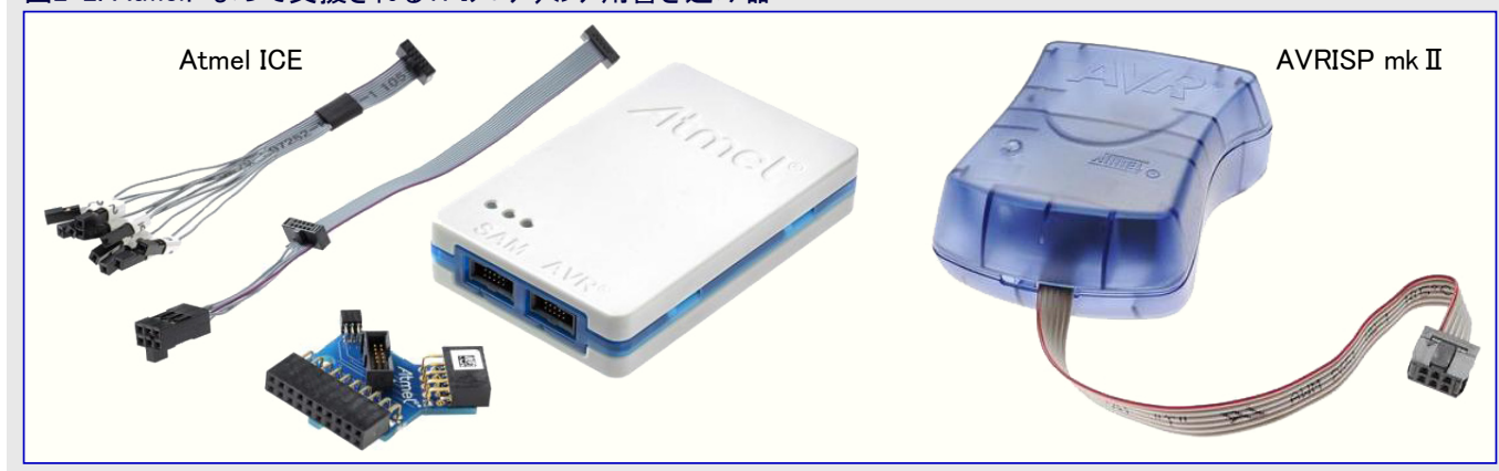
図2-2. Atmelによって支援されるTPI ® プログラミング用書き込み器
