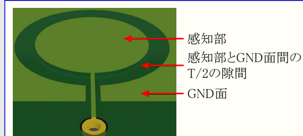
図4-4. 感知部近くのGND充填
