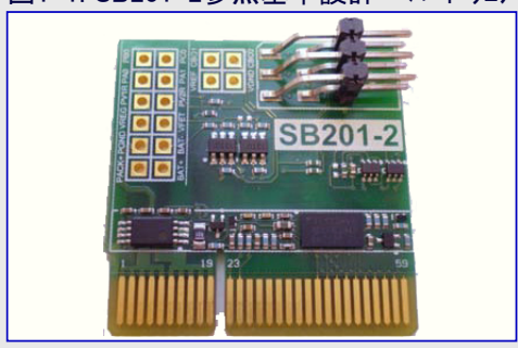
図1-1. SB201-2参照基準設計 - ハードウェア
