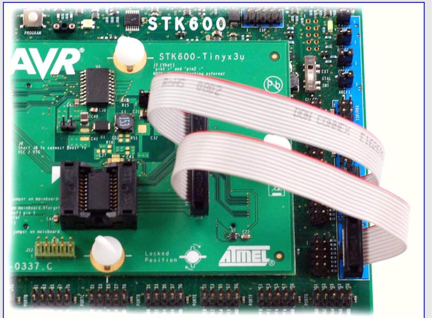
'Device and Signature Bytes(デバイスと識票のバイト)'領域で'Read Signature(識票読み込み)'をクリックすることによって接続を調べてください。ATtiny43Uに対する正しい識票は\$1E,\$92,\$0Cです。
