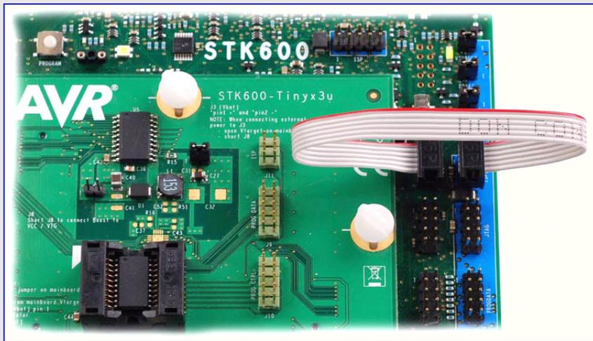
'Device and Signature Bytes(デバイスと識票のバイト)'領域で'Read Signature(識票読み込み)'をクリックすることによって接続を調べてください。ATtiny43Uに対する正しい識票は\$1E,\$92,\$0Cです。
