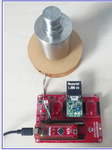
図5-3. 構成設定4 - 重量計上の1kg物体での実演構成
