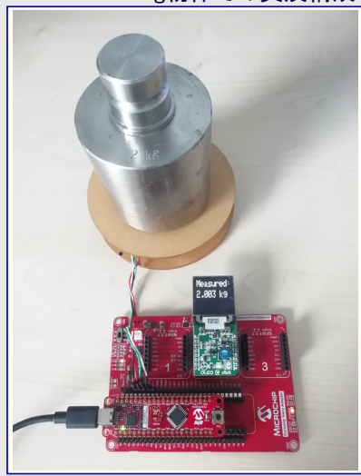
図5-5. 構成設定4 - 重量計上の 2kg物体での実演構成
