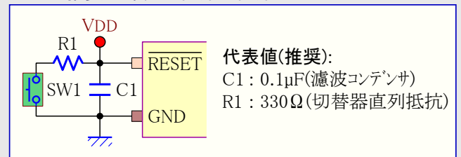
図4-3. 推奨外部リセット回路の回路図
