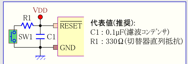
図4-4. 推奨外部リセット回路の回路図
