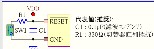
図4-2. 推奨外部リセット回路の回路図
