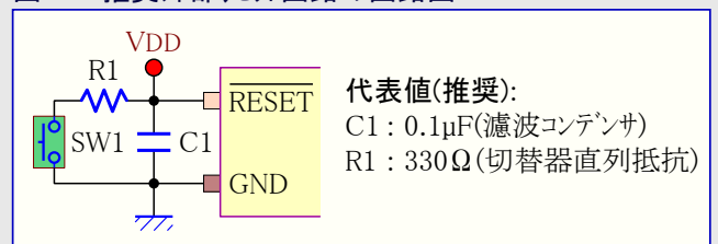
図4-3. 推奨外部リセット回路の回路図
