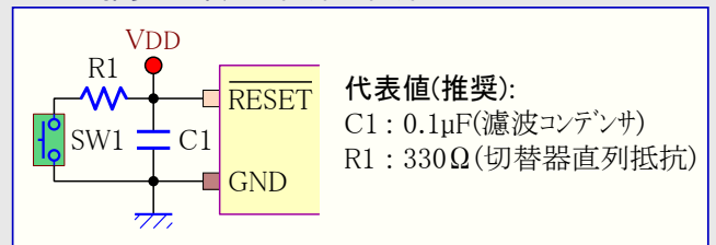
図4-3. 推奨外部リセット回路の回路図
