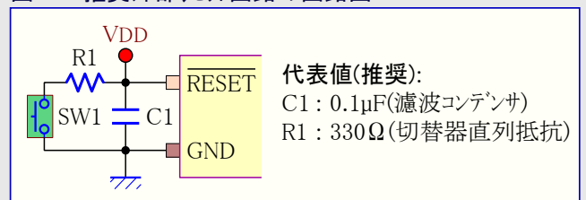
図4-3. 推奨外部リセット回路の回路図
