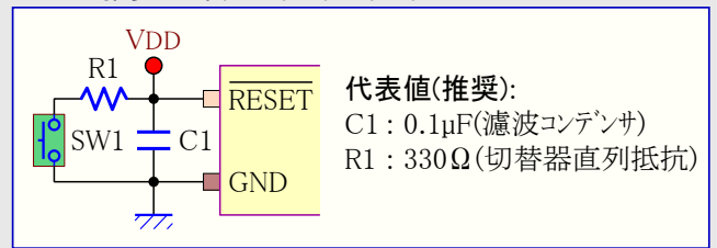
図4-3. 推奨外部リセット回路の回路図
