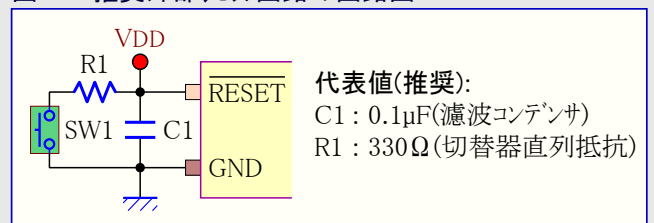
図4-3. 推奨外部リセット回路の回路図
