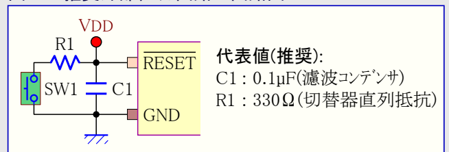
図4-4. 推奨外部リセット回路の回路図
