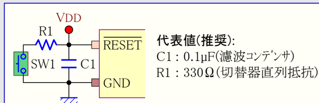
図5-2. 推奨外部リセット回路の回路図
