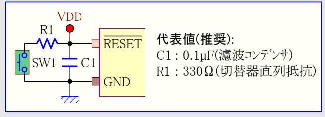
図4-2. 推奨外部リセット回路の回路図
