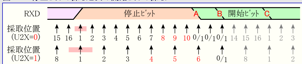
図17-8. 停止ビットの採取と次の開始ビットの採取
