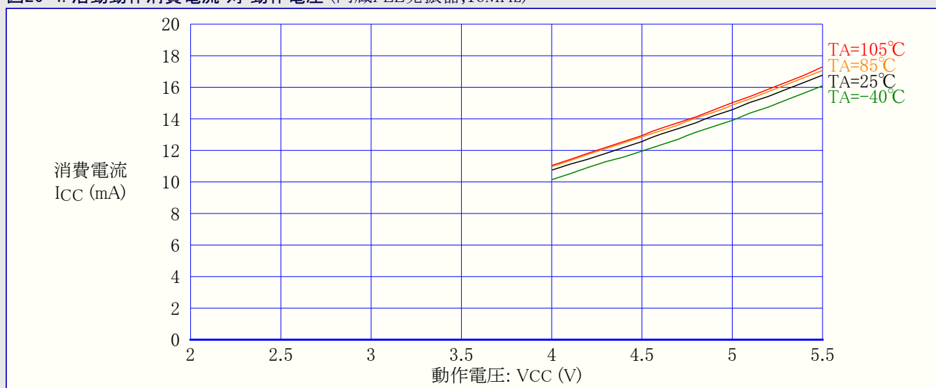
図26-4. 活動動作消費電流 対 動作電圧 (内蔵PLL発振器,16MHz)
