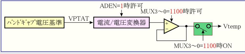
ADMUXレジスタでのA/Dチャンネル選択(MUX3~0)ビットの'1100'書き込みによるADC12チャンネル選択が温度感知を許可します(129頁の「AD MUX – A/D変換多重器選択レジスタ」をご覧ください)。温度感知器測定に関して推奨されるA/D変換基準源は内部2.56V基準電圧です。温度感知器が許可されると、A/D変換器は温度感知器上の電圧を測定するために単独変換動作で使うことができます。増幅器は最大A/D変換クロック速度でA/D変換器の採取/保持コンデンサの充電を許します。測定した電圧は表15-1.で記述されるように温度に対して直線的な関連を持ちます。基準電圧が2.56Vと等しい時に変換結果は温度に対して概ね1 LSB/°C(または2.5mV/°C)の相関を持ち、温度測定の代表的な精度は変位(オフセット)校正後で±10°Cです。
