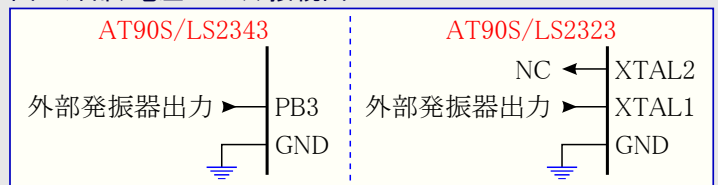
図4. 外部ク電圧レベル接続図
