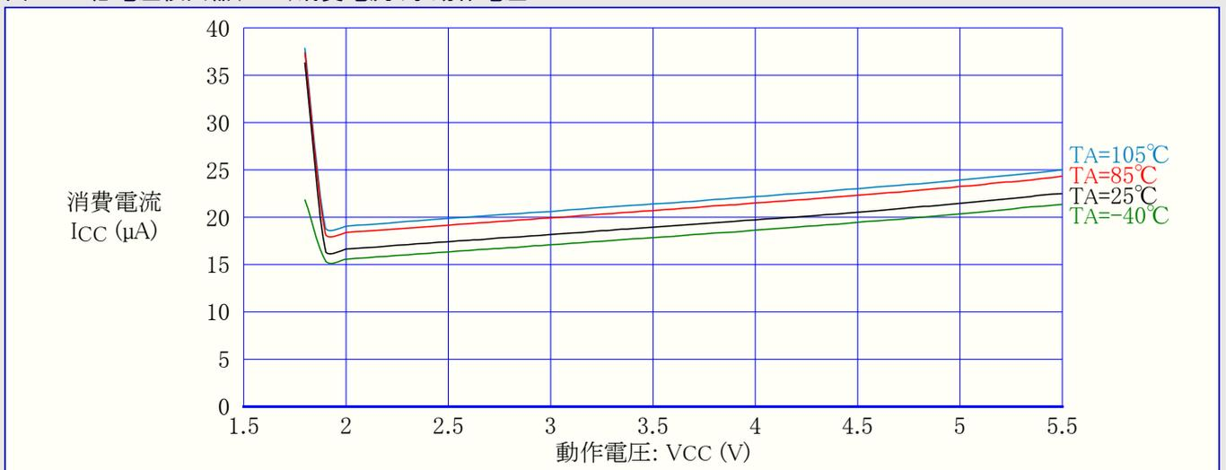
図2-12. A/D変換器消費電流 対 動作電圧 ( $f=1\text{MHz}$ )
