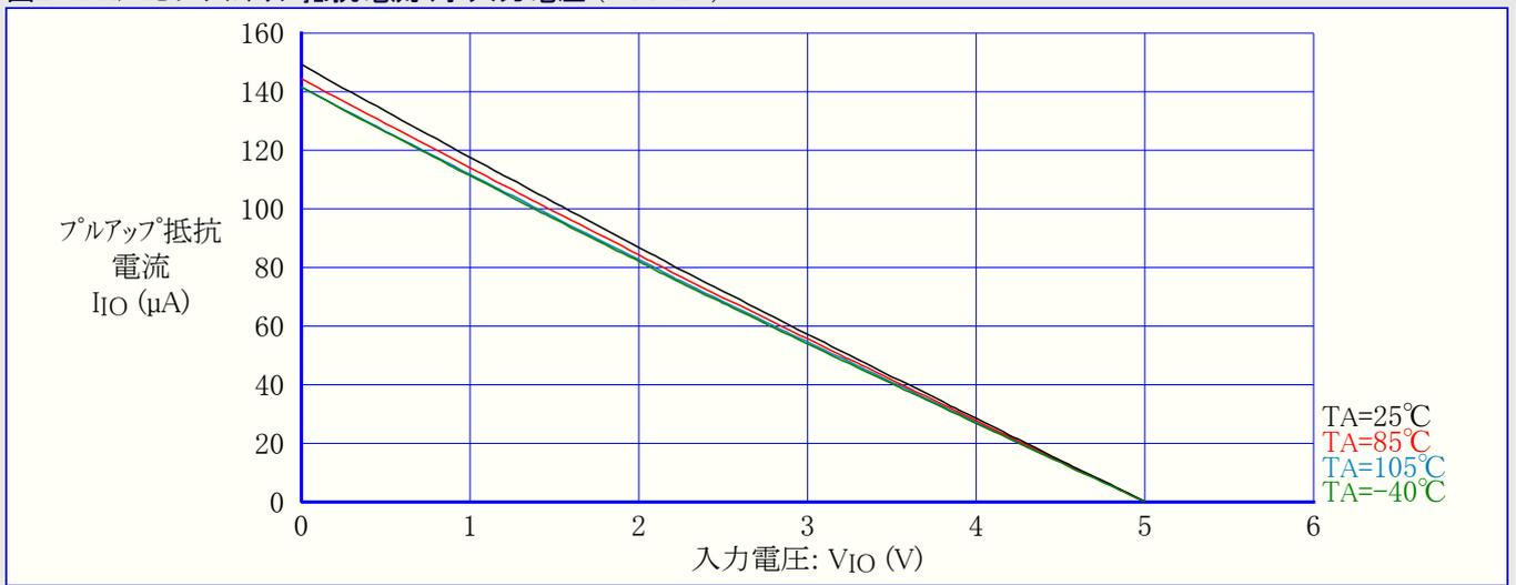
図2-18. RESETプルアップ抵抗電流 対 入力電圧 (VCC=1.8V)
