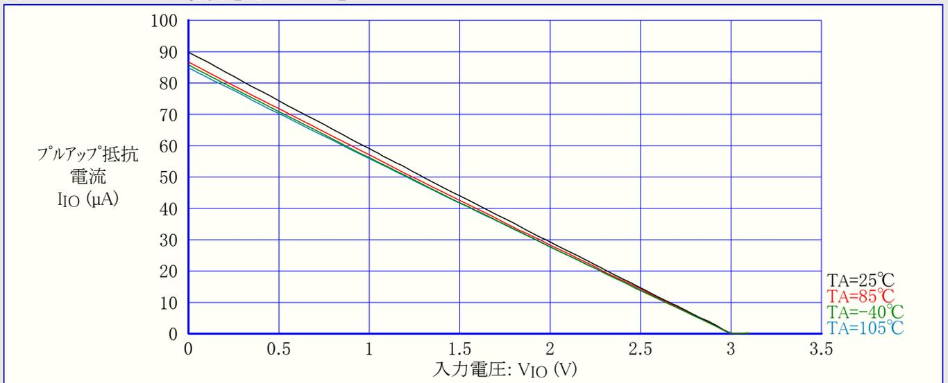
図2-17. I/Oピンプルアップ抵抗電流 対 入力電圧 (VCC=5V)
