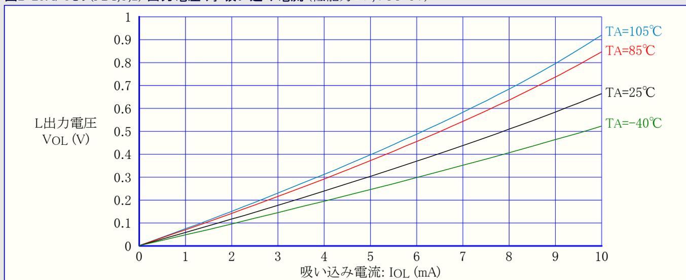
図2-26. I/Oピン(PB4,3,2) 出力電圧 対 吸い込み電流 (低能力ピン,VCC=5V)
