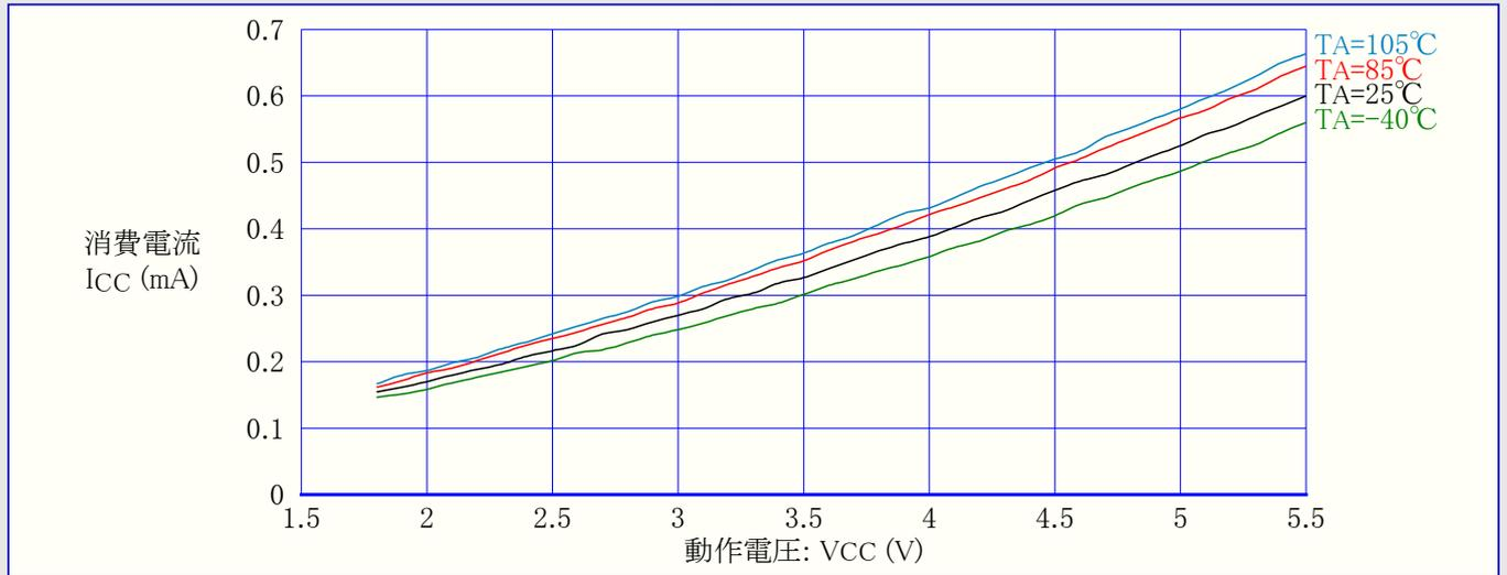
図2-7. アイドル動作消費電流 対 動作電圧 (内蔵WDT発振器, 128kHz)
