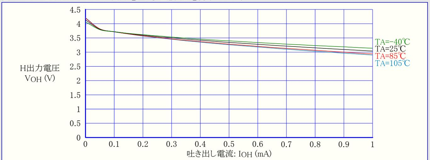
図2-36. I/OとしてのRESETピンの出力電圧 対 吸い込み電流 (VCC=1.8V)
