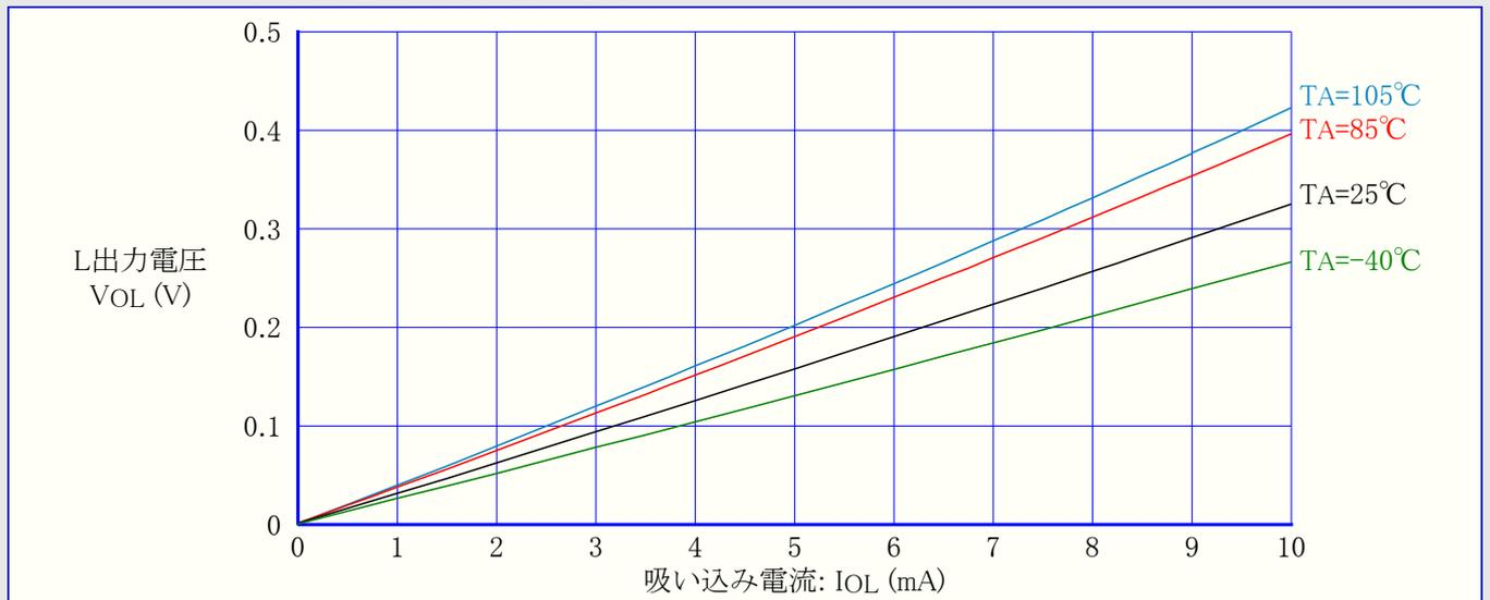
図2-32. I/Oピン(PB1,0) 出力電圧 対 吸い込み電流 (VCC=5V)
