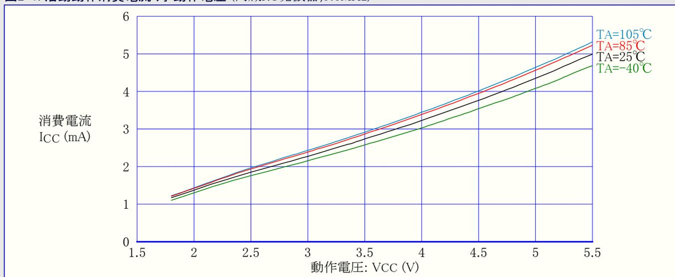
図2-2. 活動動作消費電流 対 動作電圧 (内蔵RC発振器,4.8MHz)
