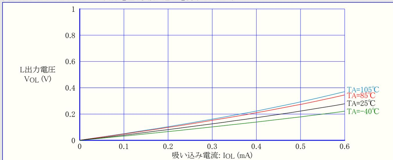
図2-37. I/OとしてのRESETピンの出力電圧 対 吸い込み電流 (VCC=3V)
