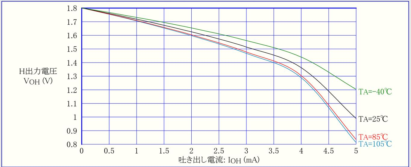
図2-22. I/Oピン(PB4,3,2) 出力電圧 対 吐き出し電流 (低能力ピン, VCC=3V)
