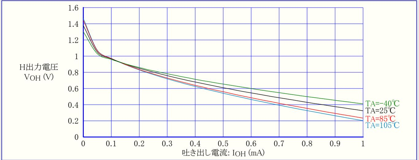
図2-34. I/OとしてのRESETピンの出力電圧 対 吐き出し電流 (VCC=3V)
