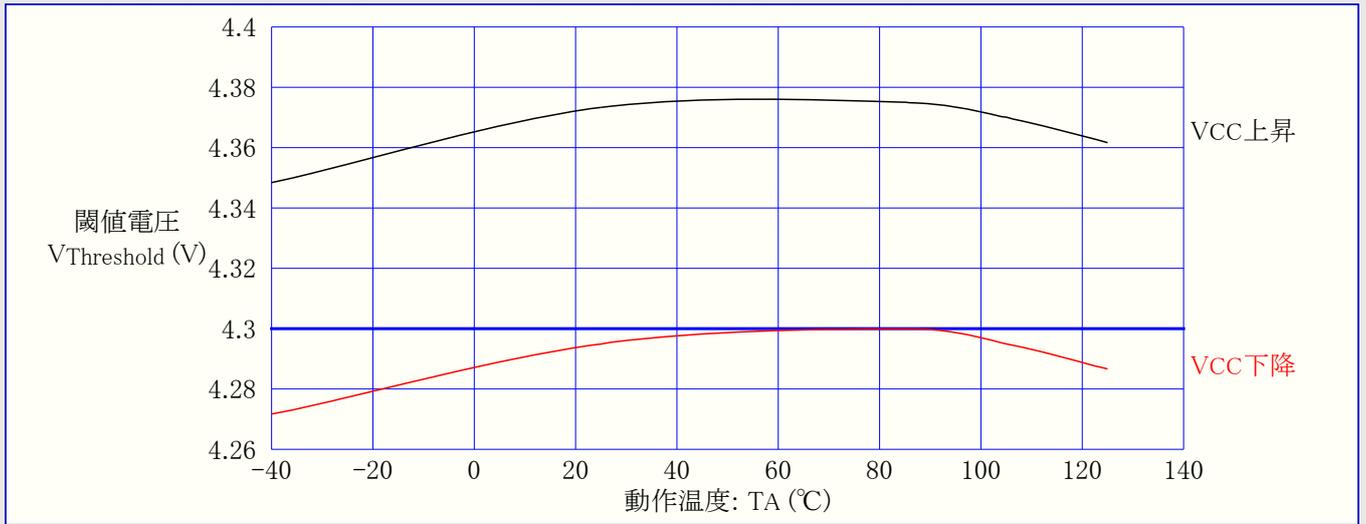
図2-46. 低電圧検出器(BOD)閾値(スレッショルド)電圧 対 動作温度 (検出電圧2.7V)
