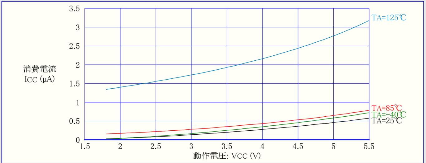
図2-10. パワーダウン動作消費電流 対 動作電圧 (ウォッチドッグ タイマ許可)
