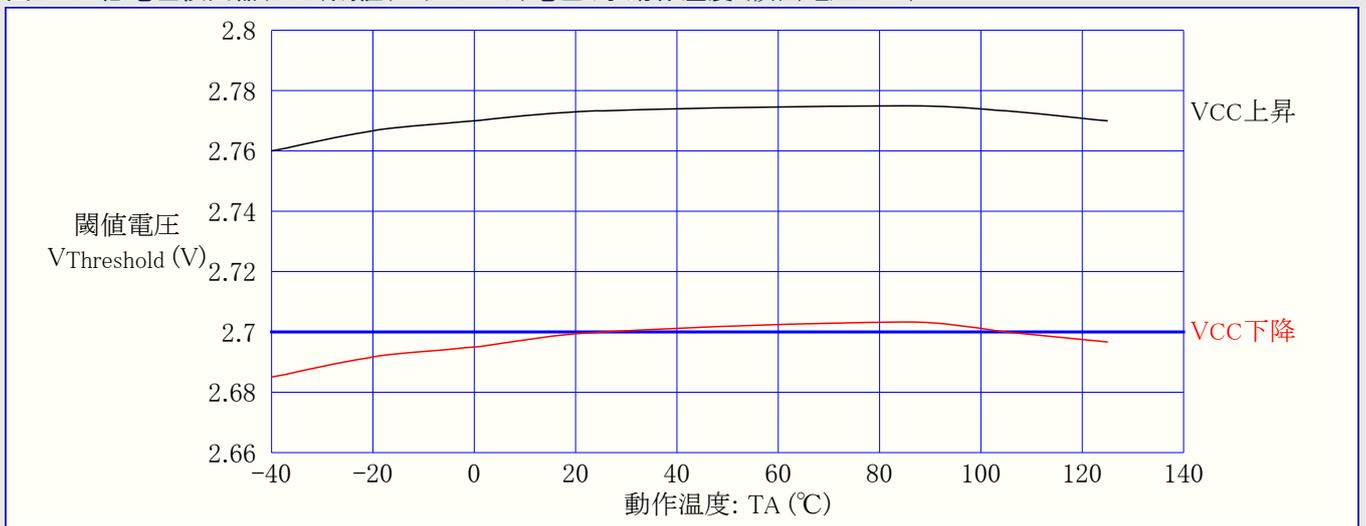
図2-47. 低電圧検出器(BOD)閾値(スレッショルド)電圧 対 動作温度 (検出電圧1.8V)
