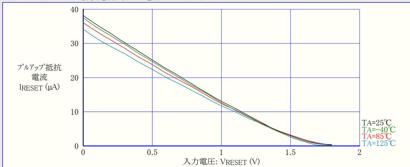
図2-19. RESETプルアップ抵抗電流 対 入力電圧 (VCC=3V)
