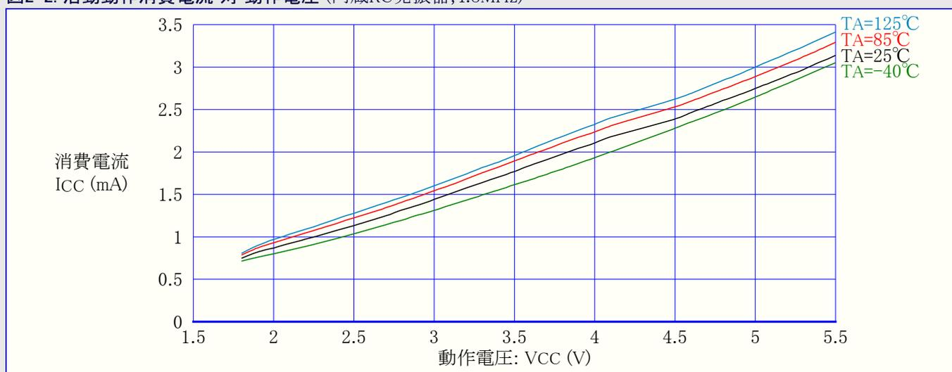
図2-3. 活動動作消費電流 対 動作電圧 (内蔵WDT発振器,128kHz)
