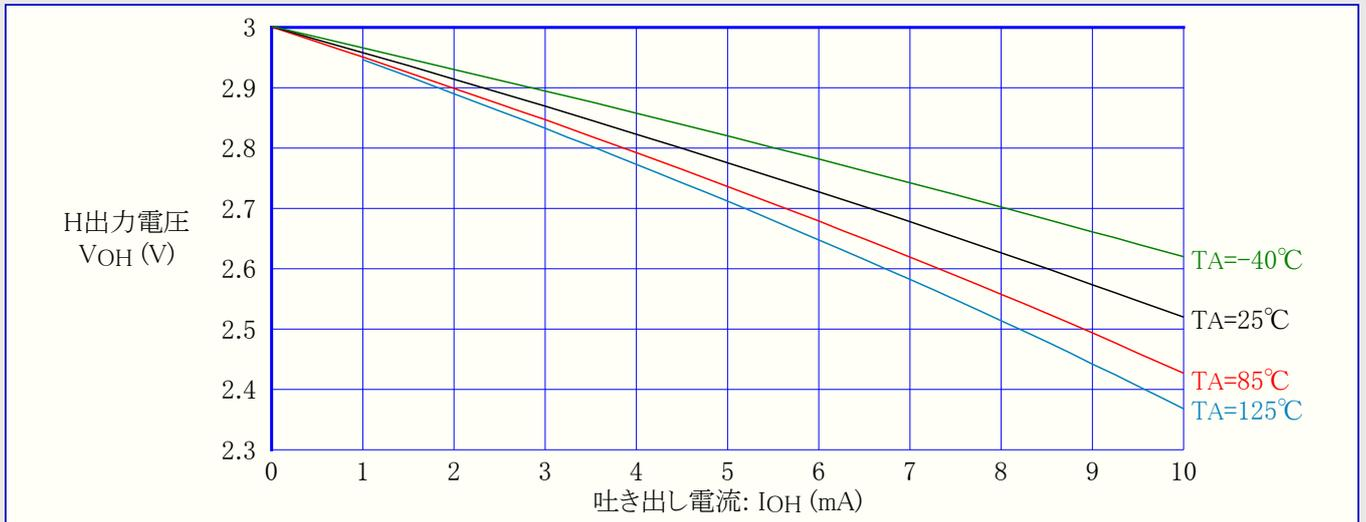
図2-23. I/Oピン(PB4,3,2) 出力電圧 対 吐き出し電流 (低能力ピン, VCC=5V)
