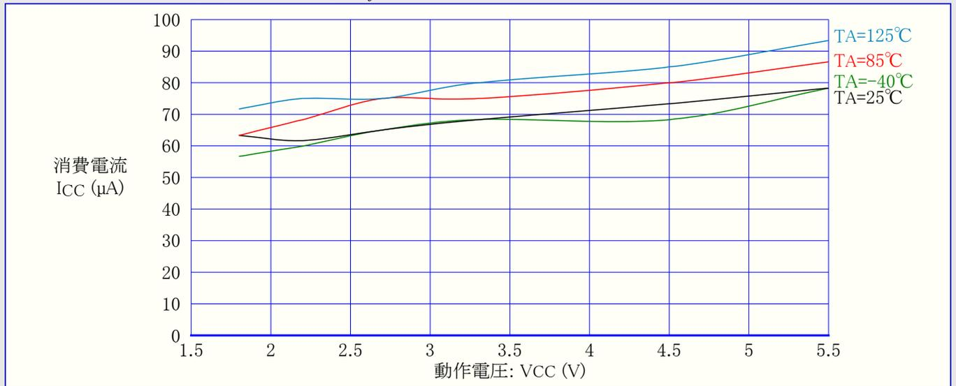
図2-14. プログラミング電流 対 動作電圧
