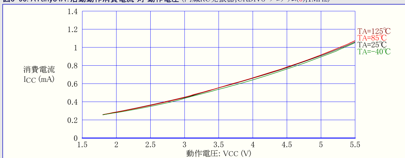
図3-95. ATtiny84A:活動動作消費電流 対 動作電圧 (内蔵RC発振器,CKDIV8=プログラム(0),1MHz)
