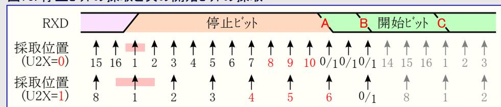
フレーム内の他のビットに対して行われるのと同じ多数決が停止ビットにも行われます。停止ビットが論理0値と記録されると、フレーミング異常(FE)フラグが設定(1)されます。
