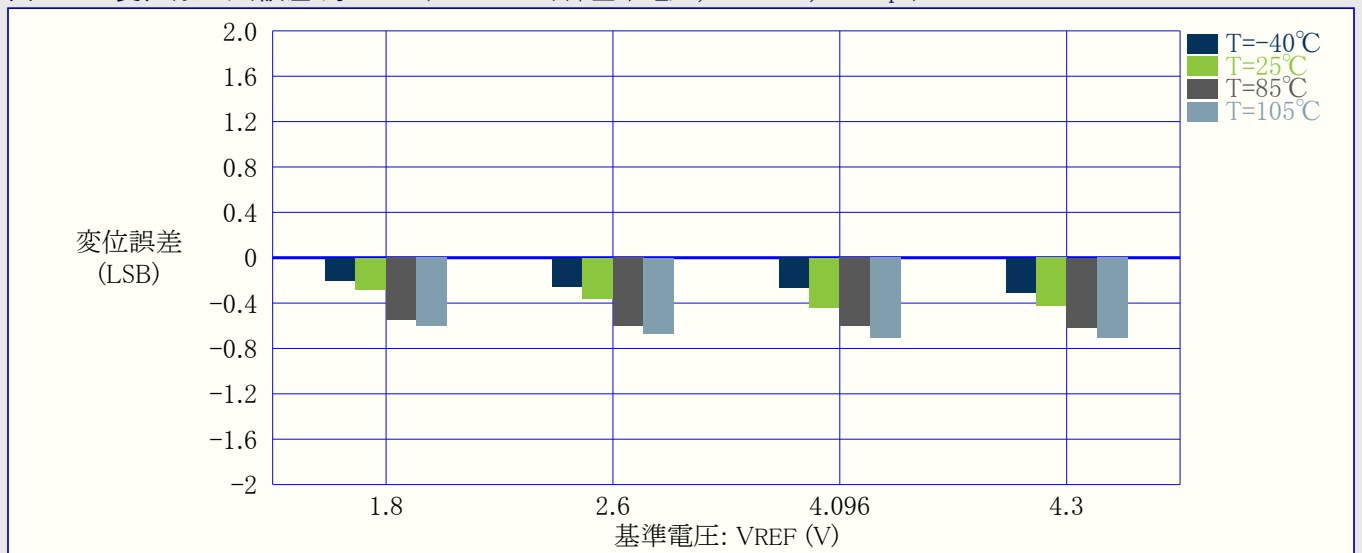
図33-63. 変位(オフセット)誤差 対 VREF (REFSEL=外部基準電圧, VDD=5V, 115kps)
