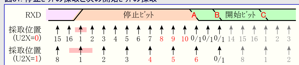
図81. 停止ビットの採取と次の開始ビットの採取
