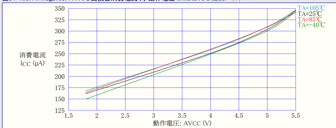
図31-109. ATmega165PA : A/D変換器消費電流 対 動作電圧 (50kHz A/D変換クロック)
