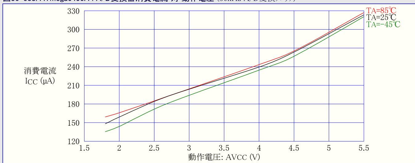
図30-539. ATmega6450A : A/D変換器消費電流 対 動作電圧 (200kHz A/D変換クロック)
