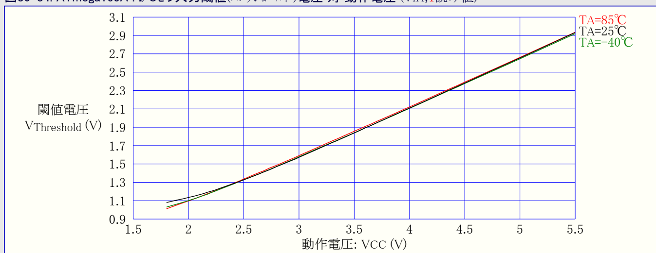
図30-34. ATmega165A : I/Oピン入力閾値(スレッショルド)電圧 対 動作電圧 (VIH, 1読み値)
