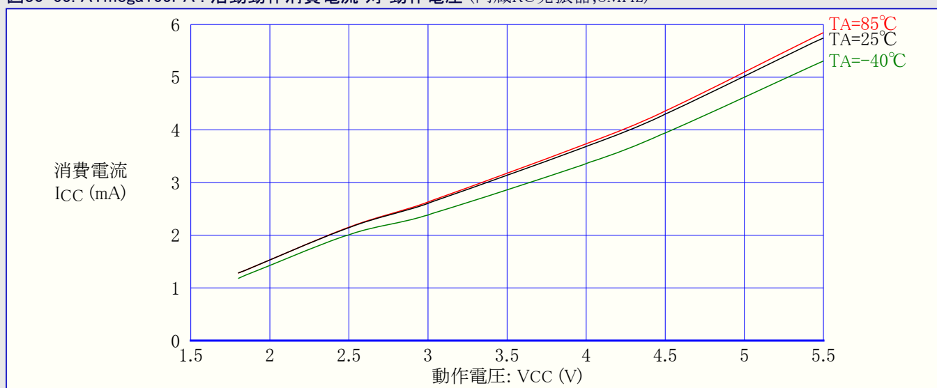
図30-65. ATmega165PA : 活動動作消費電流 対 動作電圧 (内蔵RC発振器,8MHz)
