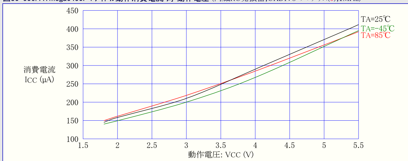
図30-556. ATmega6450P : アイドル動作消費電流 対 動作電圧 (内蔵RC発振器, CKDIV8=プログラム(0), 1MHz)
