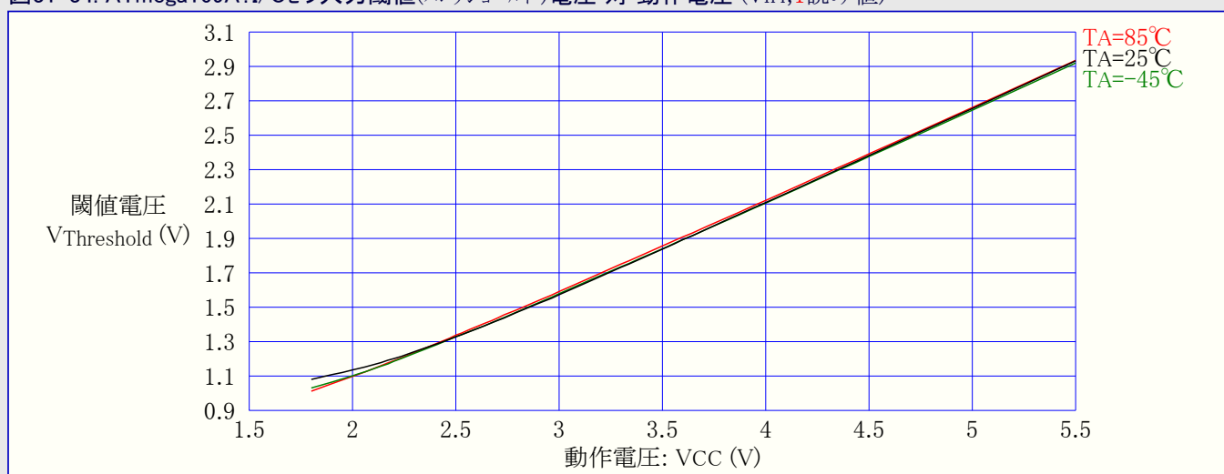
図31-34. ATmega169A:I/Oピン入力閾値(スレッショルド)電圧 対 動作電圧 ( V_{IH} , I読み値)
