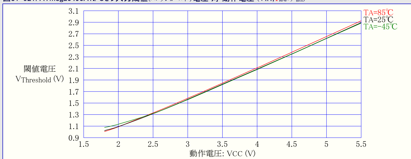
図31-521. ATmega6490A:I/Oピン入力閾値(スレッショルド)電圧 対 動作電圧 ( V_{IH} , 1読み値)
