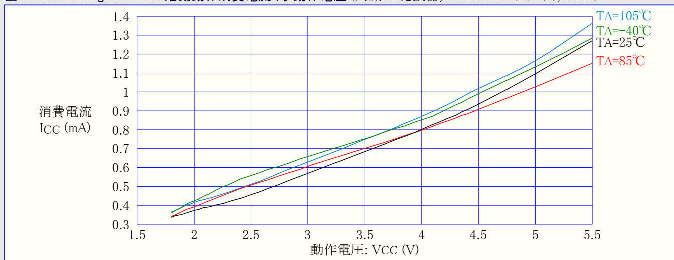
図32-310. ATmega3290PA : 活動動作消費電流 対 動作電圧 (時計用32kHzクリスタル発振子)
