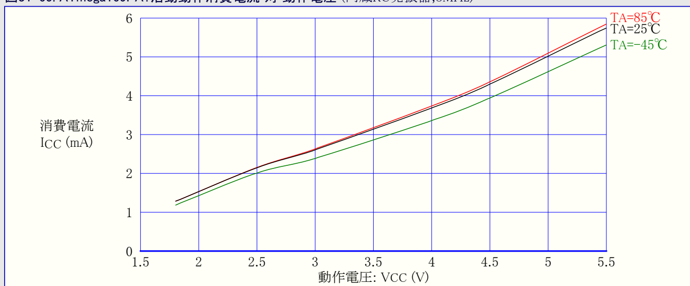
図31-65. ATmega169PA: 活動動作消費電流 対 動作電圧 (内蔵RC発振器, 8MHz)
