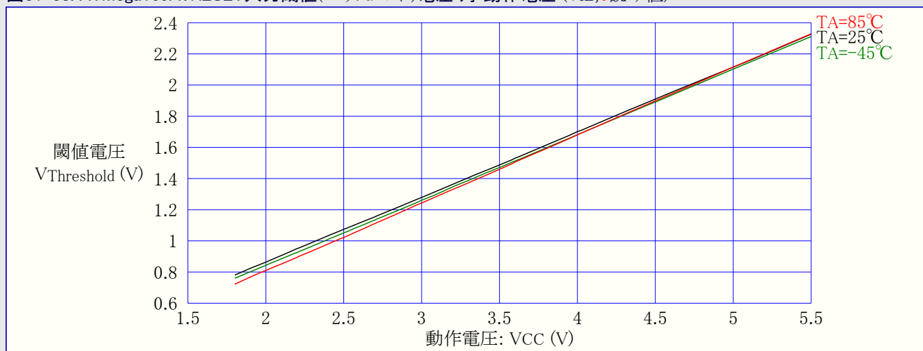
図31-38. ATmega169A: RESET入力閾値(スレッショルド)電圧 対 動作電圧 (VIL,0読み値)
