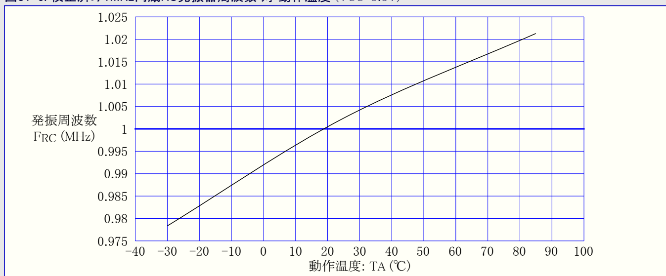
図31-6. 校正済み1MHz内蔵RC発振器周波数 対 動作温度 (VCC=3.3V)
