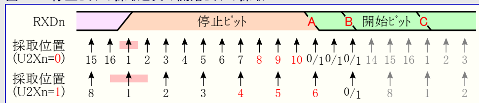
図18-7. 停止ビットの採取と次の開始ビットの採取
