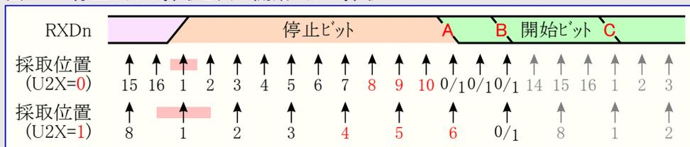
フレーム内の他のビットに対して行われるのと同じ多数決が停止ビットにも行われます。停止ビットが論理0値と記録されると、フレーミング異常(UCSRnA.FE)フラグが設定(1)されます。
