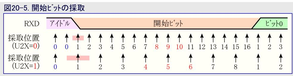
クロック再生論理回路がRXDn信号線でHigh(アイトル)からLow(開始)の遷移を検出すると、開始ビット検出手順が開始されます。図で示されるように採取1は最初のLow採取を意味します。その後にクロック再生回路は有効な開始ビットが受信されるかを決めるために、標準速動作に対して採取8,9,10、倍速動作に対して採取4,5,6(図の赤数字(訳注:原文は箱枠内)で示された採取番号)を使います。これら3回で2回以上の採取が論理Highレベルの場合(多数決)、この開始ビットは尖頭雑音として捨てられ、受信部は次のHighからLowの遷移を探し始めます。けれども有効な開始ビットが検出されると、クロック再生論理回路は同期化され、データ再生が開始されます。この同期化手順は各開始ビット毎に繰り返されます。
