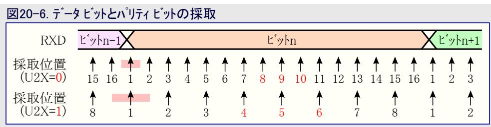
受信したビットの論理値の決定は受信したビット中央の3採取で論理値の多数決を取ることによって行われます。この中央の3採取は図上の赤文字(訳注:原文は箱枠内)の採取番号によって強調されます。多数決の手順は次のように行われます。2または全3採取がHighレベルならば受信したビットは論理1が記録されます。2または全3採取がLowレベルならば受信したビットは論理0が記録されます。この多数決手順はRXDnピンの到着信号に対して低域通過濾波器(ローパスフィルタ)のように働きます。この再生手順はその後に完全なフレームが受信されるまで繰り返されます。これには最初の(第1)停止ビットを含みます。受信部がフレームの最初の停止ビットだけを使うことに注意してください。
