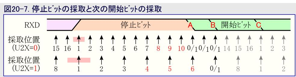
フレーム内の他のビットに対して行われるのと同じ多数決が停止ビットにも行われます。停止ビットが論理0値と記録されると、フレーミング異常(FEN)フラグが設定(1)されます。
