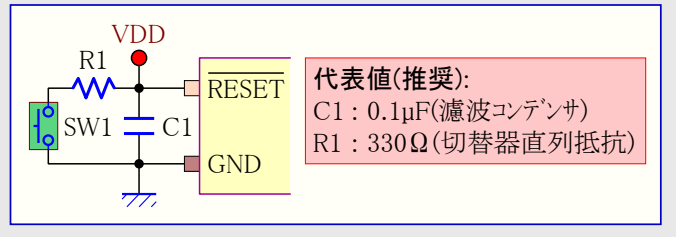
図4-2. 推奨外部リセット回路の回路図
