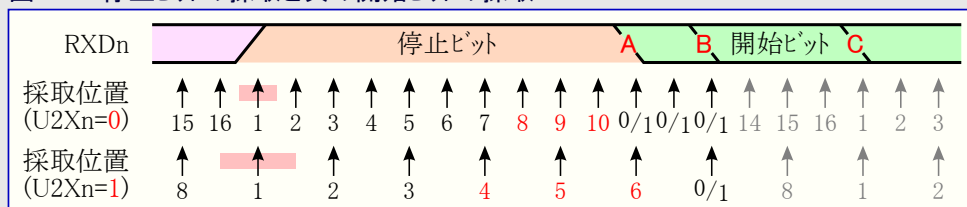
図16-7. 停止ビットの採取と次の開始ビットの採取
