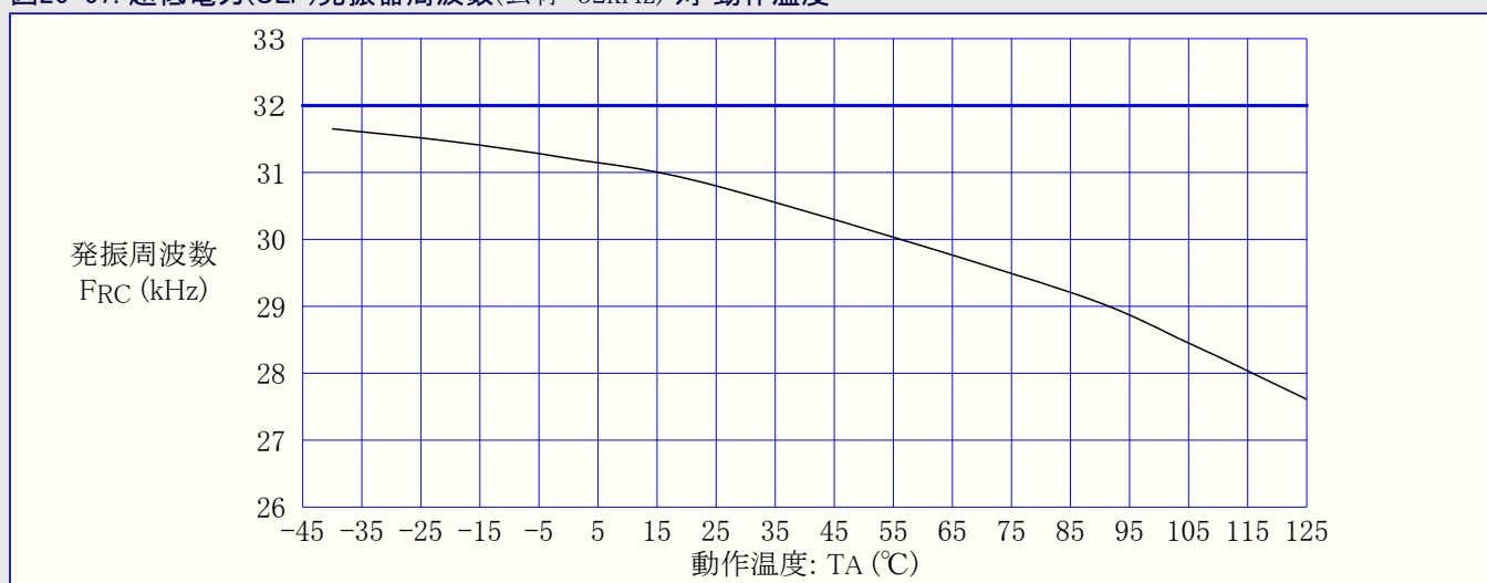
図26-67. 超低電力(ULP)発振器周波数(公称=32kHz) 対 動作温度
