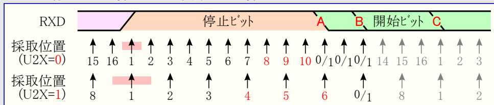
図14-7. 停止ビットの採取と次の開始ビットの採取
