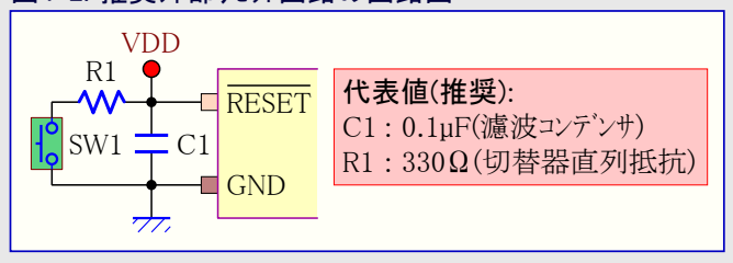
図4-2. 推奨外部リセット回路の回路図
