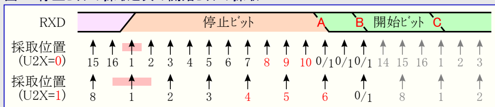
図62. 停止ビットの採取と次の開始ビットの採取
