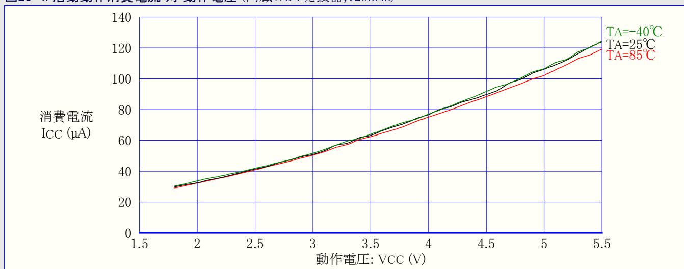
図23-4. 活動動作消費電流 対 動作電圧 (内蔵WDT発振器,128kHz)
